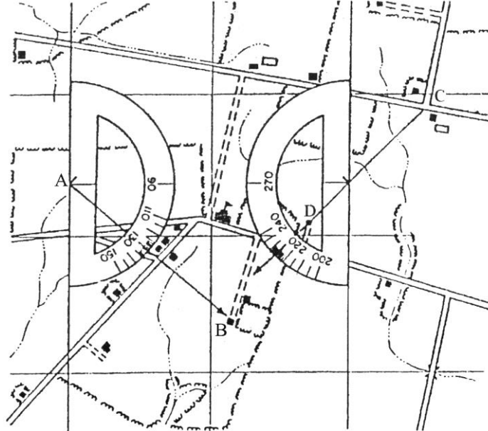
Şəkil 72. Direksion bucağın ölçülməsi
