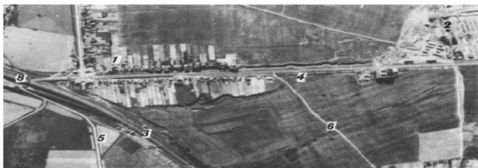
Şəkil 90. 1/14 000 miqyaslı aerofotoşəkil üzərində yerli obyektlər: 1-yaşayış məntəqəsi; 2-kərpic zavodu; 3-dəmir yolu; 4-abadlaşdırılmış şosse; 5-şosse; 6-torpaq yol; 7-körpü; 8-yol keçidi; 9-çay; 10-bərə keçidi; 11-liman; 12-karxana
