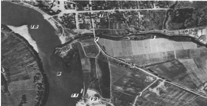
Şəkil 89. b. 1/5000 miqyaslı aerofotoşəkil üzərində müdafiə qurğuları və döyüş texnikası: 1-atəş mövqeyi; 2-uzun müddətli atəş qurğusu; 3-pulemyot meydançası; 4-səngərin üstü örtülü hissəsi; 5-sığınacaqda tank; 7-blindaj; 8-səngərdə tank əleyhinə top; 9-zenit qurğusu, 10-dartıcı; 11-yüngül tipli sığınacaq
