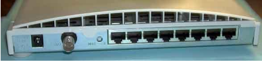
Şəkil 118. HUB-in ümumi görünüşü
